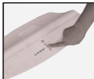
Resetten van het filter "ULPA"
